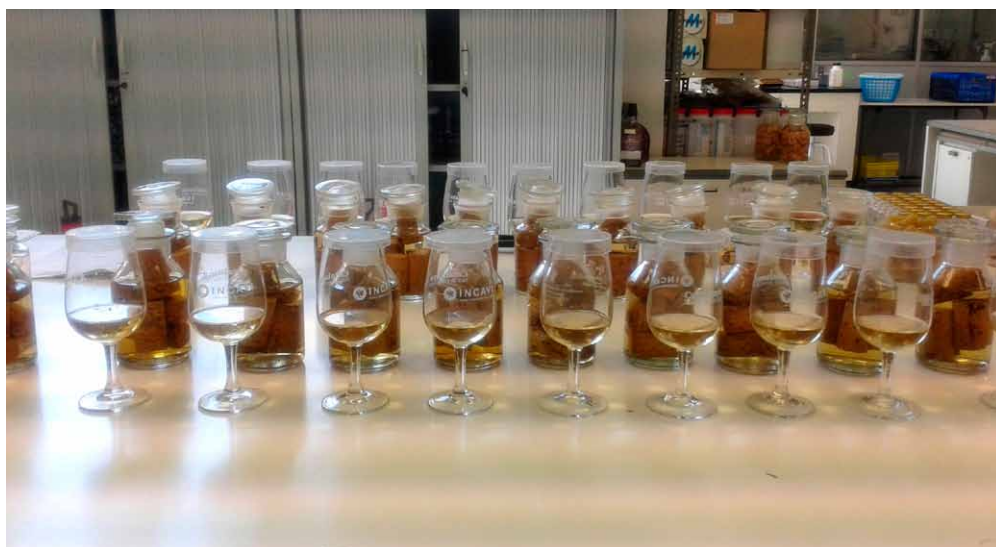
Fotografies 7-10. Assaigs físics, químics i sensorials realitzats als taps de suro català (Font: Institut Català del Suro)
